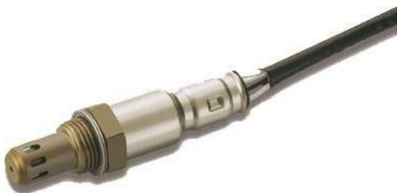
La sonda Lambda misura la quantità di ossigeno residua all'interno dei fumi di scarico e ottimizza il processo di combustione in funzione del tipo di materiale, del tiraggio e della potenza istantanea della caldaia.
