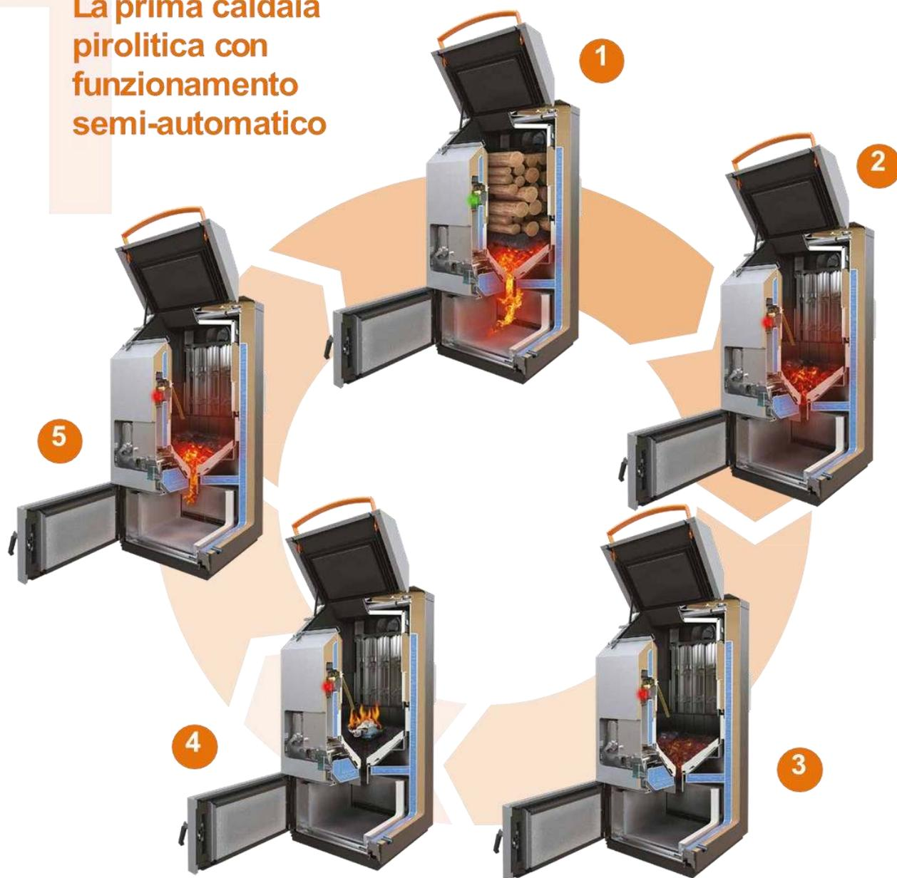
**1** **Caricamento** – dopo il caricamento del combustibile nell'intero volume della camera di stoccaggio, la combustione può durare fino a 8 ore, in funzione del tipo di combustibile e della potenza della caldaia preimpostata.
