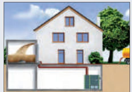
*Esempio: magazzino separato dal vano caldaia – trasporto del pellet con sistema di aspirazione pellet HDG*
