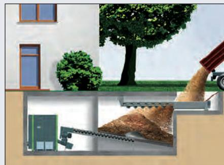
*Esempio: magazzino di deposito nella cantina con coclea di introduzione per il riempimento tramite pozzo di luce*
