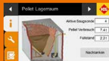
Quanto pellet ho ancora? HDG Control visualizza il livello del deposito e comunica quando è in esaurimento.
