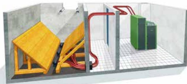
*Da tre a otto sonde di aspirazione coprono in modo ottimale ogni deposito di pellet.*
