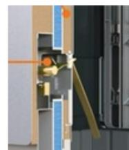
Rilevazione meccanica del combustibile residuo
