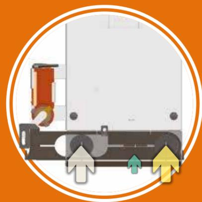
L'aria di pre-essiccazione e l'aria primaria sono aperte al 100 %, l'aria secondaria è completamente chiusa. Il registro dell'apporto dell'aria si trova in tale posizione in caso di combustione di legna umida o di grandi ceppi.
