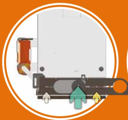
L'aria secondaria è aperta al 100 %, l'aria di pre-essiccazione e l'aria primaria sono completamente chiuse. Il registro dell'apporto dell'aria si trova in tale posizione in caso di combustione di legna secca o bricchette, in cui è necessaria una maggiore quantità d'aria secondaria per una combustione efficace.
